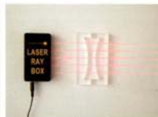
konkavno sočivo sa kontaktima staklo-staklo (nema prelamanja)
