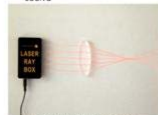
zraci se fokusiraju pomoću konveksnog sočiva
